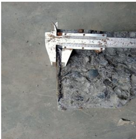
Gambar 7. Hasil Pengujian penetrasi Air pada Beton CS2-3, dengan Nilai Penetrasi Air = 0,75cm
