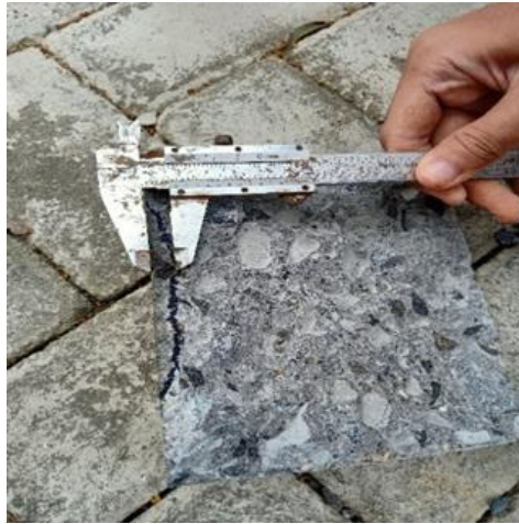
Gambar 8. Hasil Pengujian Penetrasi Air pada Beton CS3-1, dengan Nilai Penetrasi Air = 0,83cm
