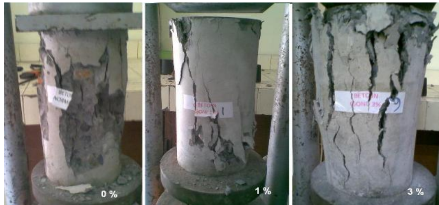
Gambar 1 Pola retakan uji kuat tekan beton serat goni
