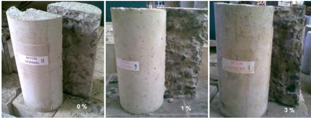
Gambar 2 Pola retakan uji kuat tarik beton serat GONI
